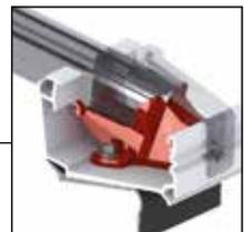
**Una soluzione efficace per impedire la propagazione dell'incendio sul tetto (a norma DIN 18234)**
